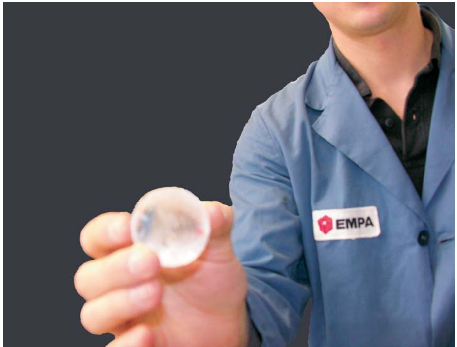
Hagelwiderstands-Messung durch die EMPA mit einem 40 mm Hagelkorn. Der Beschuss erfolgt möglichst realitätsnah mit Eiskugeln anstelle von Kugeln aus Kunststoff.
