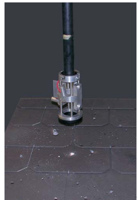
Mehrfacher Beschuss an verschiedenen Stellen auf das Dachsystem Eternit DACHSCHIEFER 600 x 400 mm mit einer 40 mm Eiskugel. Es sind weder technische noch optische Veränderungen nach dem Beschuss festzustellen.
