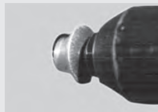
Setzen des Niertes mit 6 mm langer Festpunkthülse
