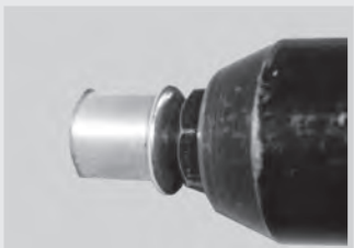
Setzen des Niets mit 16 mm langer Festpunkthülse
