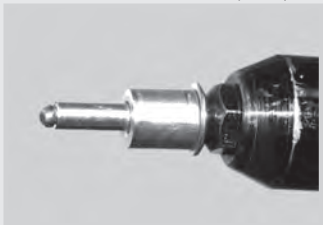
Stülpedeckung sichtbar (Plattendicke 8 mm) oder unsichtbar (Plattendicke 12 mm) befestigt: Niet mit aufgesetzter 16 mm langer Festpunkthülse
