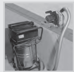
FESTO-Kreissäge mit Führungsschiene und Staubabsaugung
